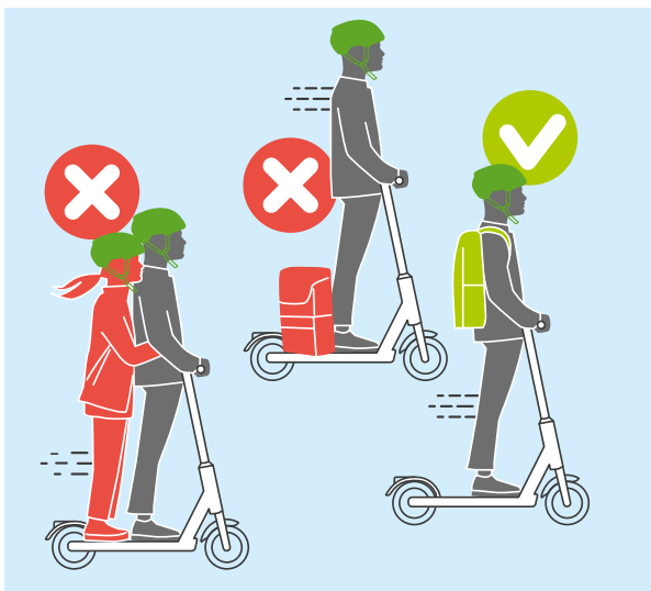
Abb. 2 Untersagt ist die Mitnahme von Menschen und Gepäck auf dem Trittbrett (Stabilität und Gleichgewicht!)
